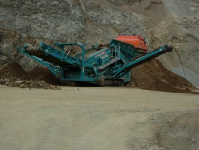
CAVA ACQUAFREDDA in Comune di Castiglione Chiavarese (GE) - vaglio per la cernita dei materiali terrosi.
